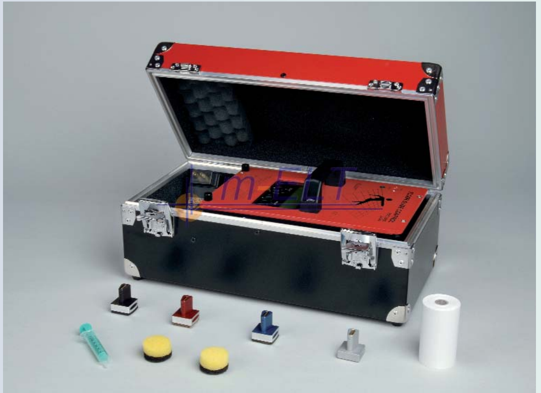
Met FSC2000 apparaat wordt wrijvingscoëfficiënt tussen zoolmaterialen en tegeloppervlak gemeten. Metingen vinden plaats in droge en natte toestand. De resultaten worden ingedeeld in zekerheidsklassen die onder meer worden toegepast in het Protocol Antislipvloeren van het Handboek Woonkeur (voorheen Seniorenlabel).
