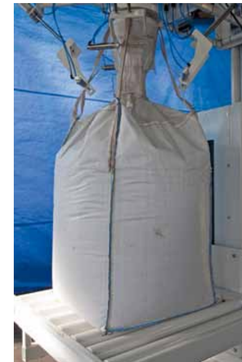
Langzaam wordt de bigbag over de vulmond van de robot geschoven >>
