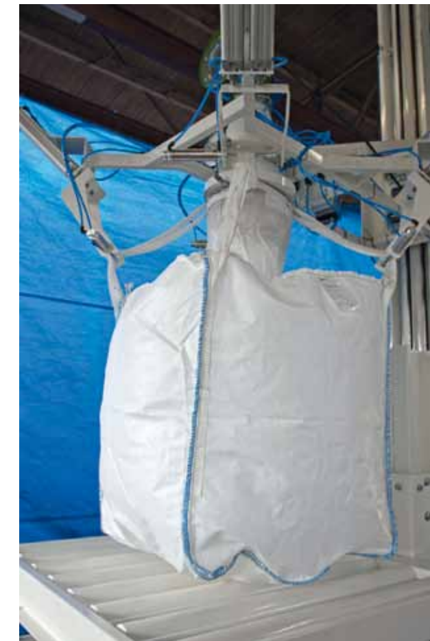
Langzaam wordt de bigbag over de vulmond van de robot geschoven >>
