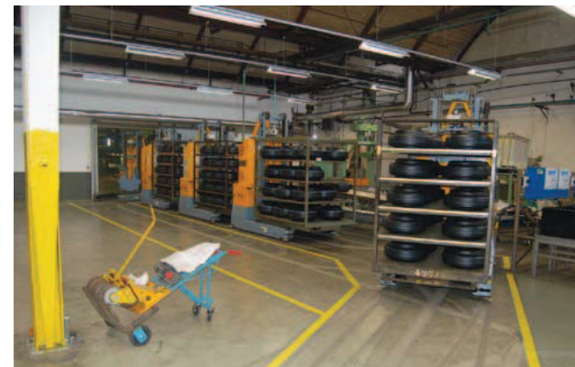
Het kritieke punt was bereikt; de batterijen van de AGV's waren toe aan vervanging
